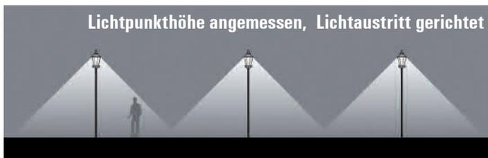
Darstellung Gleichmäßigkeit der Lichtverteilung anhand veränderter Lichtpunkthöhen und Lichttechnik
