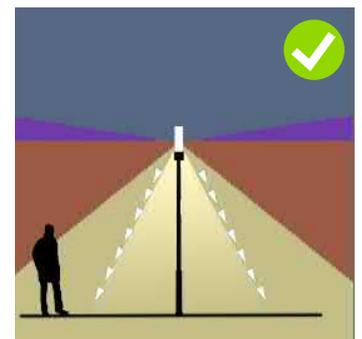
Aufsatzleuchte mit Lichtlenkung
