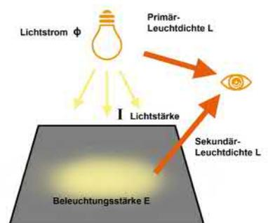
Abbildung Lichttechnische Grundgrößen
