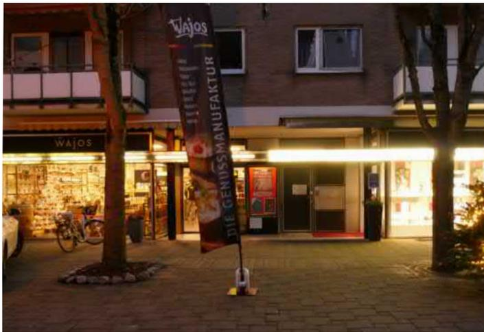
Das Einzelhandelsgeschäft links im Bild wird durch die hohen Leuchtdichten der selbstleuchtenden Werbetafel und des Schaufensters des Nachbargeschäfts überstrahlt. Hohe Leuchtdichten verursachen Blendung und dominieren den Straßenraum.
